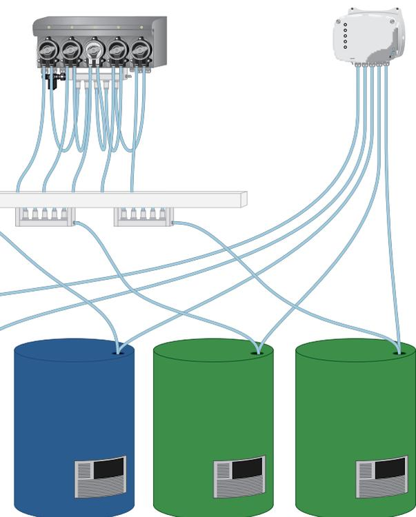
Les Dosalinges coffret inox offrent différents débits de pompes : 20L/h - 30L/h - 60L/h en fonction de la charge de la machine à laver.
